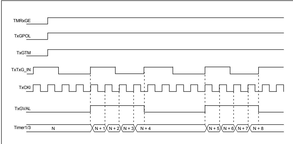
**FIGURE 13-6: TIMER1/3 GATE SINGLE-PULSE MODE**
