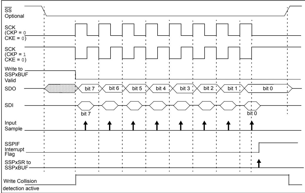
**FIGURE 16-10: SPI MODE WAVEFORM (SLAVE MODE WITH CKE = 1)**
